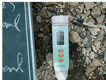
水澄マイル投入後PH測定 PH=7.1
